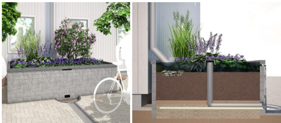
Figur 14. Upphöjd växtbädd i anslutning till byggnad (Bildkälla: Tengbomgruppen) samt principskiss för upphöjd biofilterkonstruktion (Vinnova 2014).
