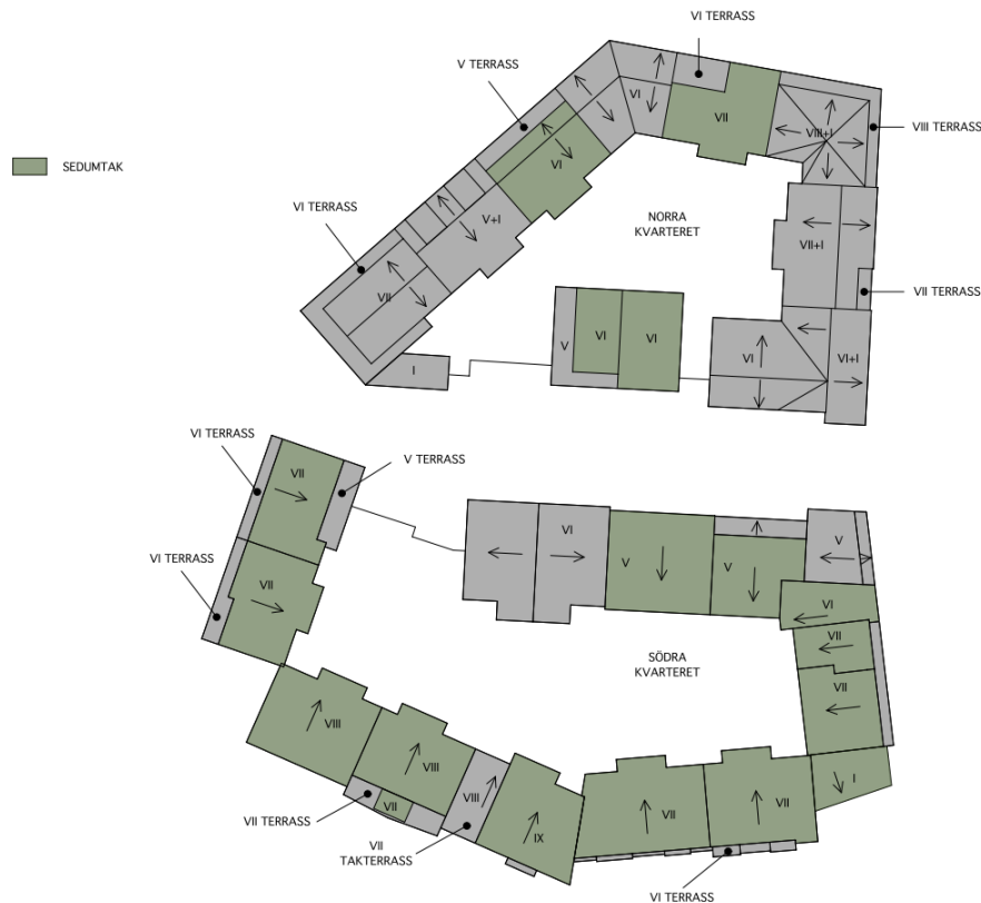
Figur 11 Takplan med flödespilarsystem som visar takens lutning samt var gröna tak planeras (markerat med grönt) (ÅWL arkitekter).
